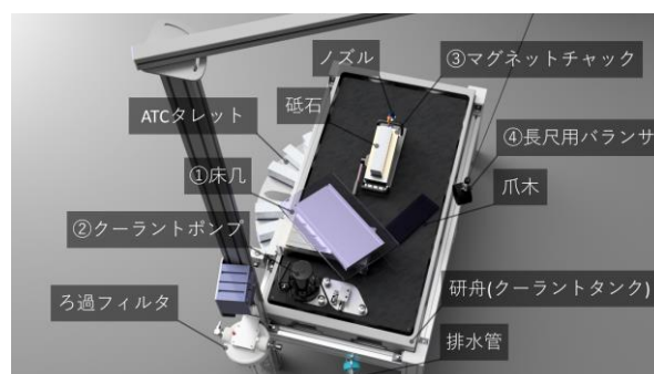
図1. 下地研ぎ専用研ぎ台(研ぎ舟)
